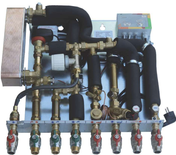
Wohnungsstation für Warmwasser- und Radiatorenheizung mit eigenem Rücklauf für Sommerbypass (Warmhaltung) mit elektronischer Regelung für WW 40-70°C steckerfertig mit Hochtemperaturabgang VL + RL 1/2"
