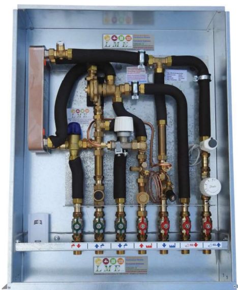
Wohnungsstation für Warmwasser und Radiatorenheizung samt Brauchwassermischer 35 - 70°C samt Kaltwasserdruckminderer 1 - 4 bar im wasserdichten UP - Kasten 810x610x150mm
