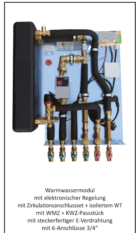
Warmwassermodul 3/4" mit elektronischer Regelung 40-70°C mit DDR 0,2-0,6bar primär mit langem WT bis ca. 40l/min mit Sommerbypass 10-50°C einstellbar
