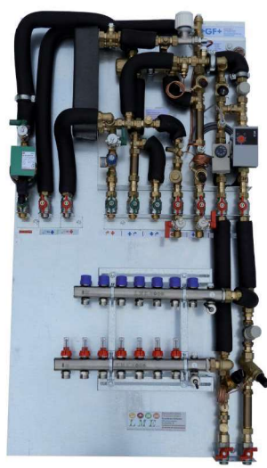
Wohnungsstation für WW mit Zirkulation, Fußbodenheizung mit Einspritzschaltung & Temperaturregelung über GLT (2 Motorventile), Fußbodenkühlung über GLT (2 Motorventile) in Aufputzausführung
