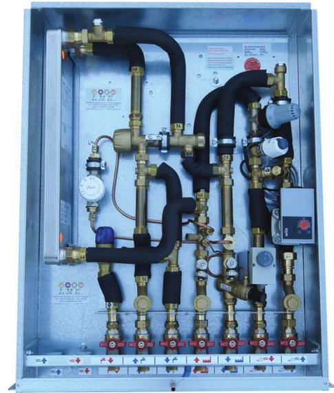
Wärmepumpen - Wohnungsstation für Warmwasser und Festwertregelung für Fußbodenheizung samt Brauchwassermischer 35 - 70°C, mit Spülmöglichkeit im primär VL + RL mit 3 Stk. Schmutzfilter T - Version im wasserdichten UP - Kasten 810x610x150mm
