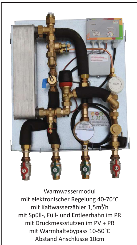
Warmwassermodul mit elekt. Regelung 40-70°C, bis ca. 130kW mit 2x Motorventil 12V, PWM1 mit DDR 1" 0,2 ÷ 0,6bar primär mit langem WT + Sommerbypass mit 5x Anschlüsse 1"
