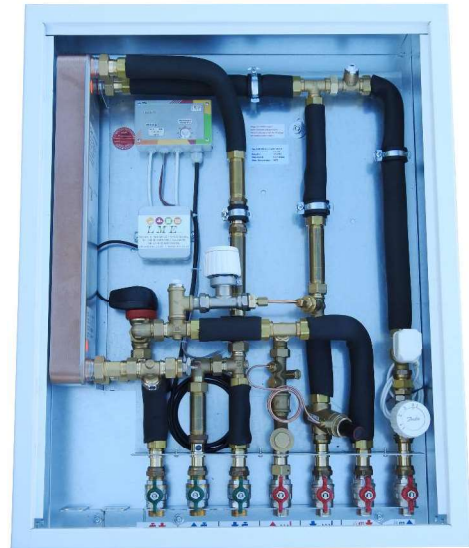
Wohnungsstation für Warmwasser- und Radiatorenheizung mit elektronischer Regelung, Zonenventil + Stellmotor Rücklauftemperaturbegrenzer in UP810x610x150mm
