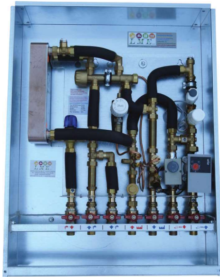
Wohnungsstation für Warmwasser und Festwertregelung für Fußbodenheizung samt Brauchwassermischer 35 - 70°C im wasserdichten UP - Kasten 810x610x150mm
